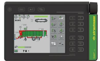
Darüber hinaus erhöhen die zahlreichen integrierten Automatikfunktionen die Bedienung der Maschine. Diese können vom Fahrer individuell ein- oder ausgeschaltet werden. Ebenfalls neu ist auch das Bedienterminal: Es ist ISOBUS kompatibel und verfügt über ein 5,7-Zoll großes Display. Die neben dem Display integrierten, intuitiv bedienbaren Folientasten bieten einen angenehmen Bedienkomfort.
