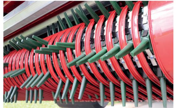
Der hydraulische Antrieb der Pick-up ermöglicht es, die Geschwindigkeit stufenlos zu regulieren und an die Fahrgeschwindigkeit des Traktors anzupassen. Die Höhenverstellung wird weiterhin wie gewohnt über ein Lochbild an den Tasträdern eingestellt. Optional kann der Magnon<sup>CFS</sup> auch mit einer zusätzlichen großen zentralen Tastrolle ausgestattet werden. Diese wird hinter der Pick-up montiert und optimiert das Fahrverhalten des Ladewagens auf nassem oder unebenem Boden.
