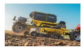
En complément, le semoir peut encore accueillir une unité de semis ALFA DRILL dotée d'une trémie de 400 litres. Cette flexibilité à trois trémies offre de larges possibilités de mise en place des cultures : semis de la culture principale associé à une application d'engrais, semis de trois types de semences ou possibilité d'appliquer des micro-granulés.
