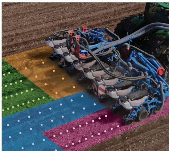
Le tout nouveau dispositif de fertilisation FertiSmart bénéficie de l'intelligence embarquée. Les rouleaux à augets distribuent une large gamme d'engrais. En effet, ils sont entraînés électriquement indépendamment l'un de l'autre, ce qui permet de varier les doses rang par rang. Les moteurs intelligents MSM (Monosem Smart Motors) permettent quant à eux un pilotage individuel des doseurs, et un démontage facile sans outil.
