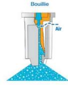
Deux grands orifices d'entrée d'air réduisent le risque de colmatage.
